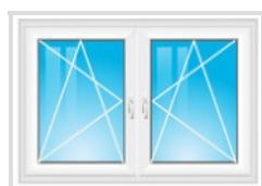
dvoudílné okno se sloupkem
