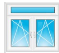
trojdílné okno se sloupkem
